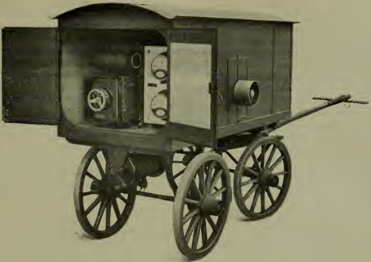
Fig. 182. — Moteur transportable pour grande puissance (Ateliers d'Oerlikon).
